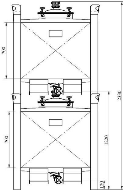
**Armaturensatz komplett bestehend aus:** Restablaufventil NW 50 auf Mz 32 oder Pf 38 mit kurzem Griff
